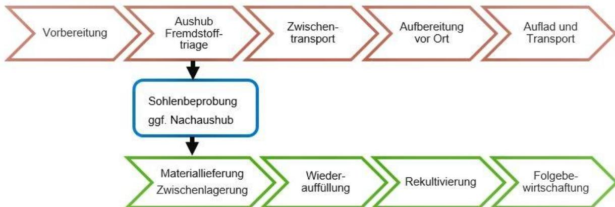
Abbildung 7: Generelle Abfolge der Arbeitsschritte Sanierung Deponien
