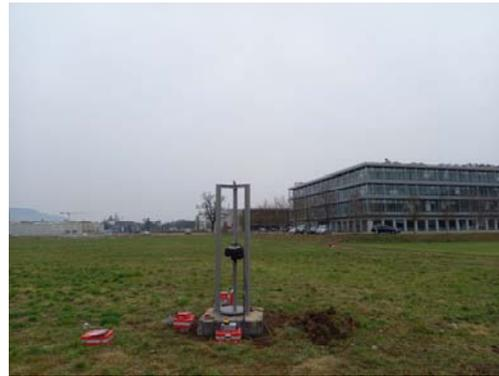
Bild 3.4 Impulsmaschine mit 120 kg Sandsack.
