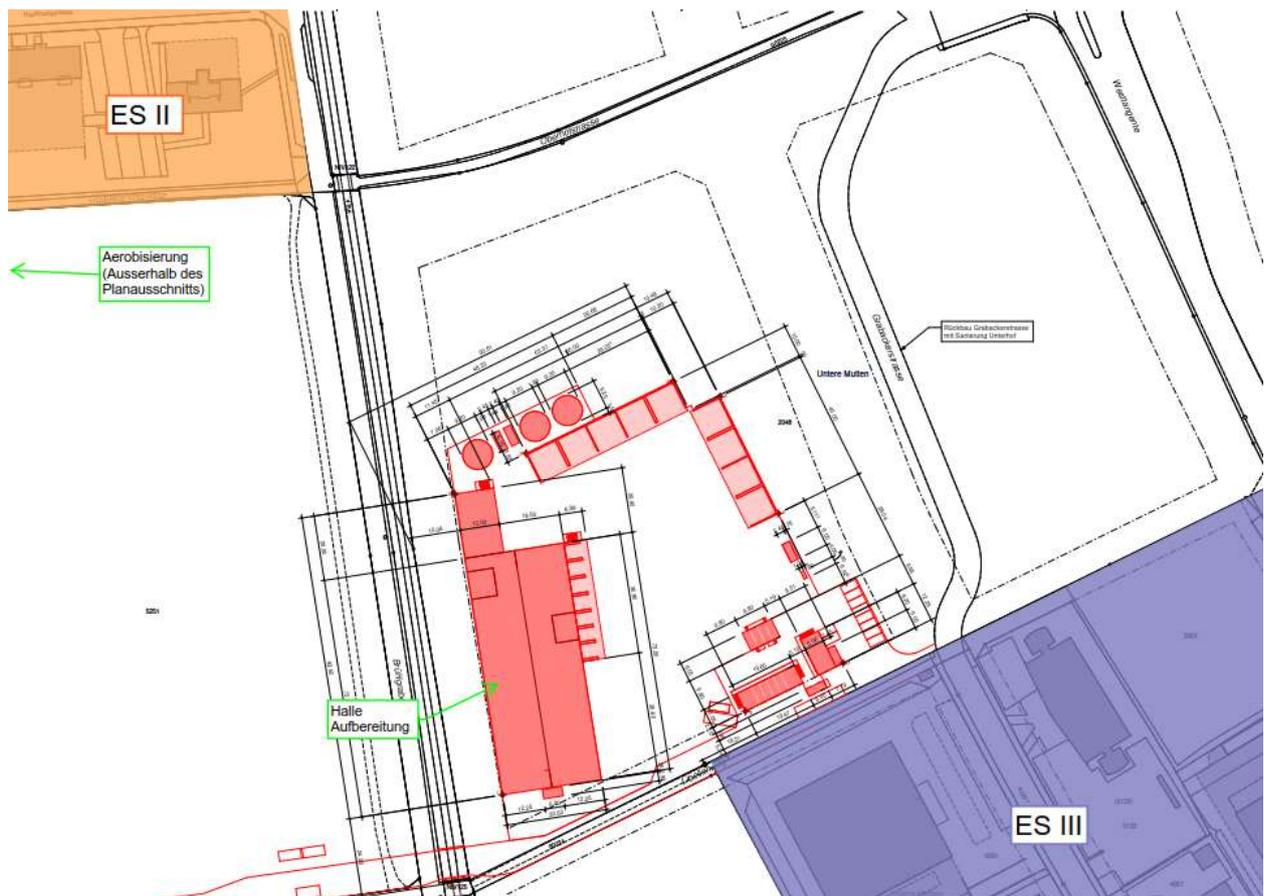
Abb. 1: Situationsplan mit der Darstellung der neuen Anlage (rot) und den betroffenen Bestandsgebäuden in der Nachbarschaft.
